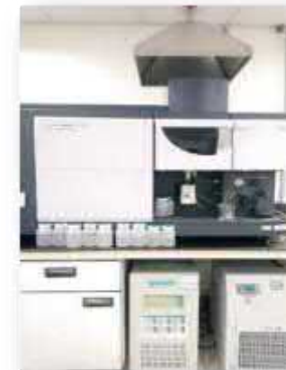
ICP感應耦合電漿原子 發射光譜儀 (f-CaO、f-MgO含量分析)
