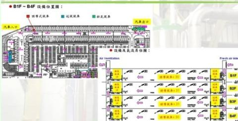
F12P4地下室停車場B1F-B4F每層樓各設置4台機械送風與4台機械排氣風車，由於停車場非24小時皆為尖峰時間全時段運轉造成多餘電力消耗。以廠區實際工作作息之停車時間，區分運轉條件為尖峰時間及離峰時間，在系統圖控上寫入時間控制程式於離峰時間停止運轉可節省風車運轉電費。每年碳排放共可減少：(1740268度)x0.623=1084187 Kg-CO<sub>2</sub>
