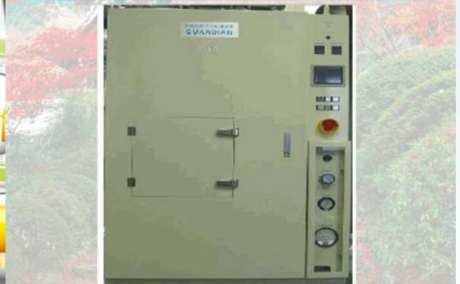
針對使用PFCs之CVD設備機台均應經過燃燒減量設施處理後使得排放，PFCs最高去除率可達90%以上
