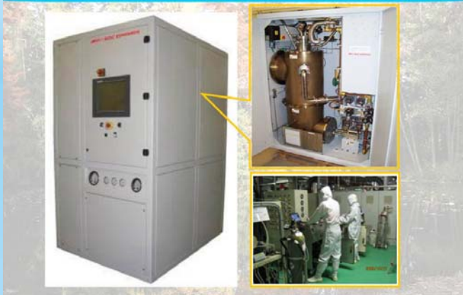
設置Burn type local scrubber處理製程尾氣，減少溫室氣體排放
