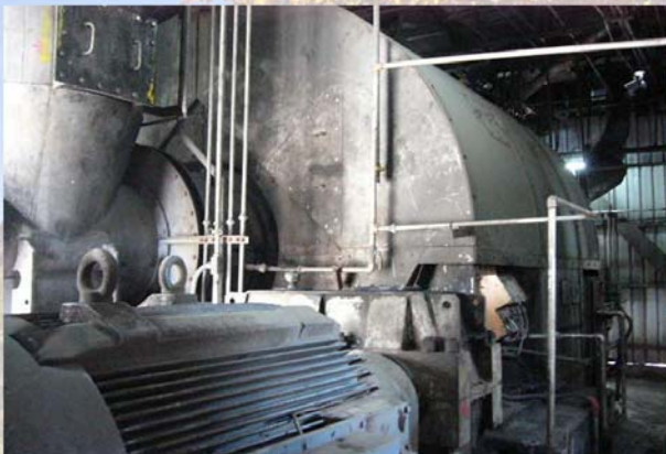
依通過粉煤細度測試200目以上比例、磨煤機增加鐵球數量。
