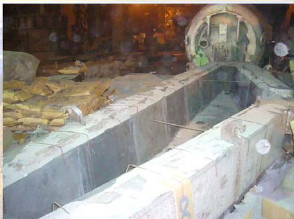
煉鋼分流槽加深，提高連鑄率，減少電力耗用。
