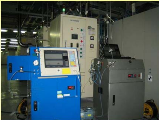
進行PFC氣體防治設備效率量測，以掌握機台設備之效能並針對效能不佳者進行改善提昇。
