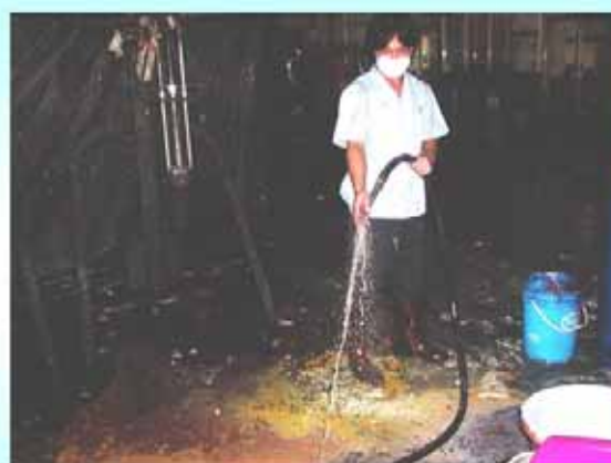
使用放流回收水清洗桶槽及網框，減少用水總量以降低電力能源。
