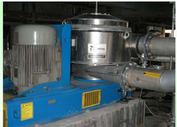
漂白一、二段淨漿系統由淨漿管式改為豎型篩以提升濃度降低用電
