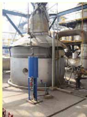
氣燃燒改用高效率 之鉑網觸媒，降低 煙囪排氣之N2O含 量
