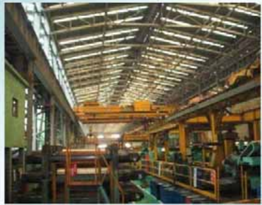
廠房屋頂透光浪板：以自然採光方式，減少照明用電。
