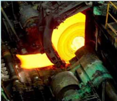
盤捲箱：藉由盤捲形式，鋼捲再均溫，並減少溫降，並減短廠房長度。
