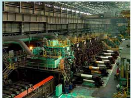
熱軋產線：藉由產速提升與作業率提高，減少加熱爐與設備怠機空轉致浪費能源。
