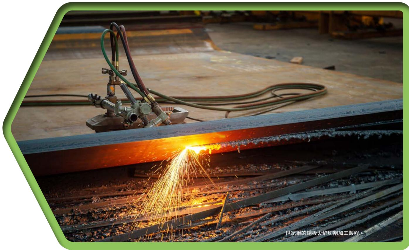
世紀鋼的鋼板火焰切割加工製程。
