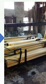
完成包膜處理銅管
