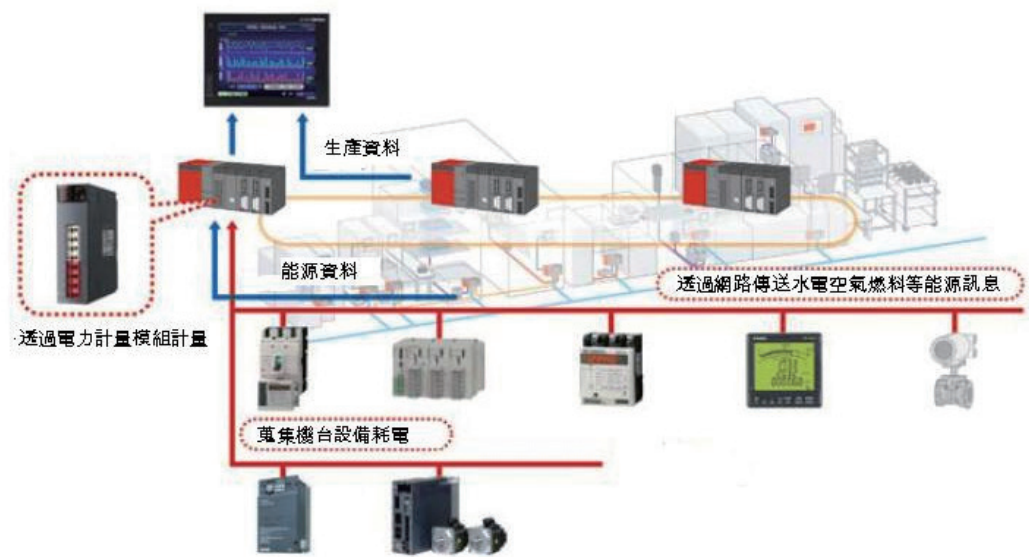
圖 1 工廠能源管理系統（FEMS）架構示意圖
