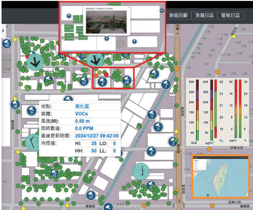
圖 2 案例廠區內毒性及可燃性氣體整合分析系統（簡稱戰情室）
