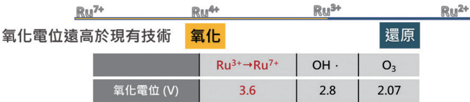
圖 2 可再生型吸附顆粒 (RAP) 與傳統高級氧化法之氧化電位
