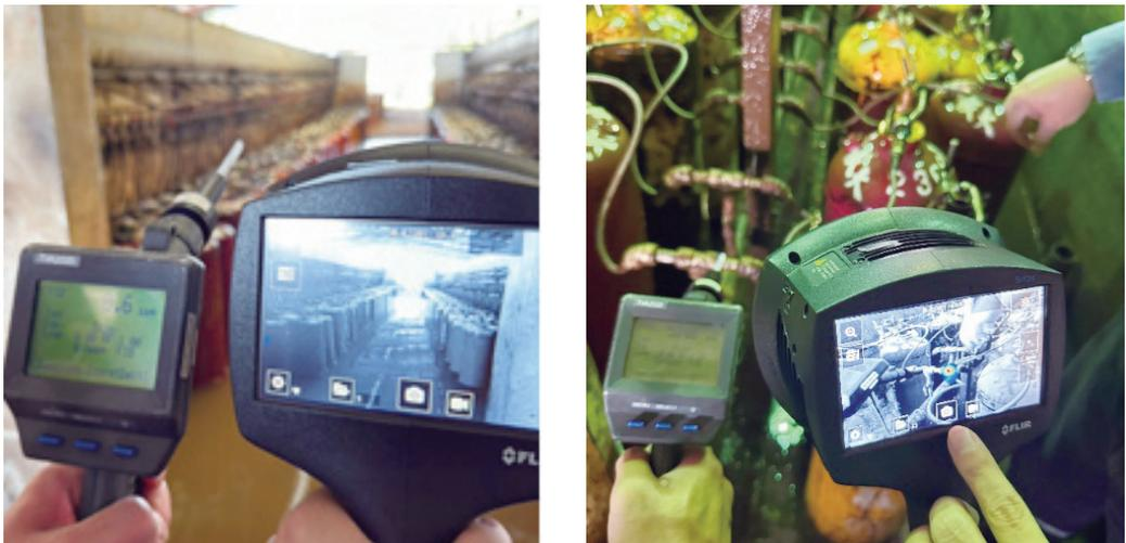
圖 7 超聲波顯像儀快速定位壓力鋼瓶乙炔洩漏
