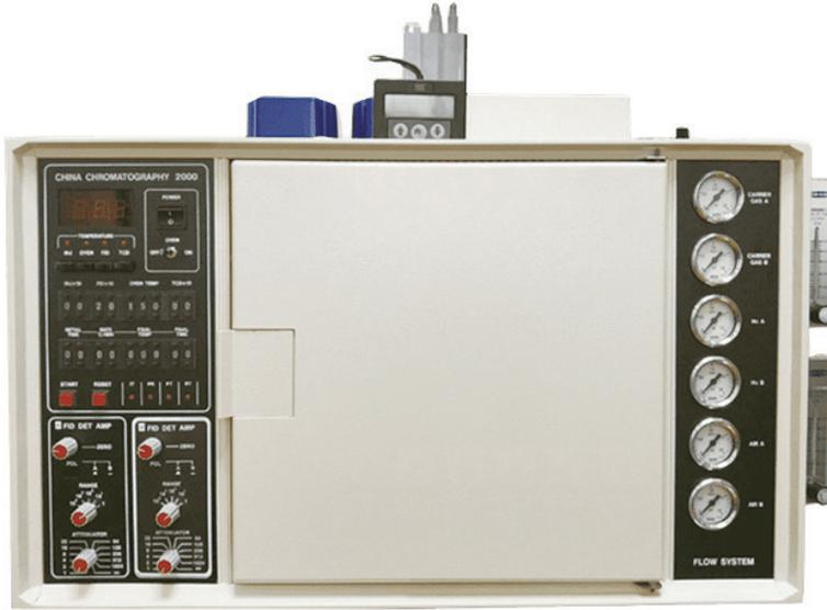
圖 1 GC-FID 儀器外觀圖 (拓堡科技)
