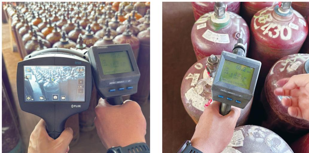
圖 8 A 廠實瓶區壓力鋼瓶乙炔洩漏
