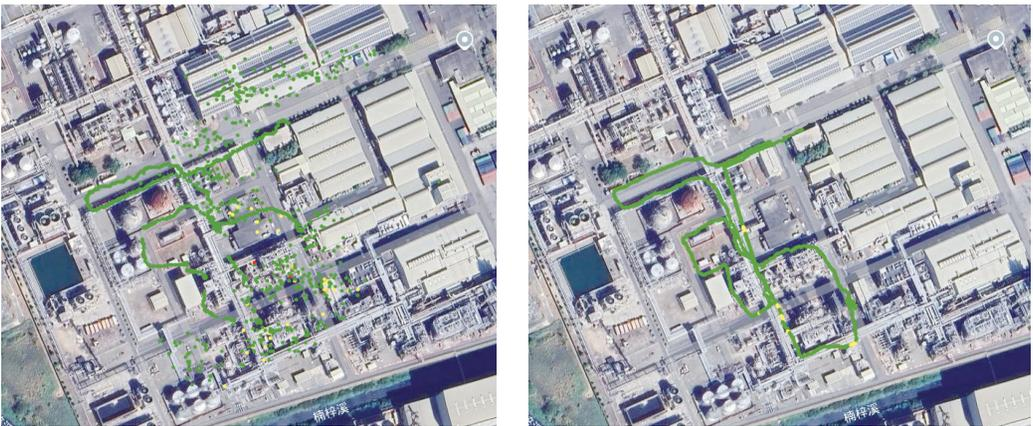
圖 11 乙廠 GPS 定位比較 (左圖僅衛星訊號, 右圖另含 Wifi 訊號)
