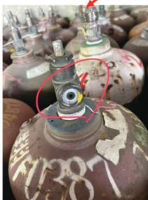
更換洩漏鋼瓶墊片
