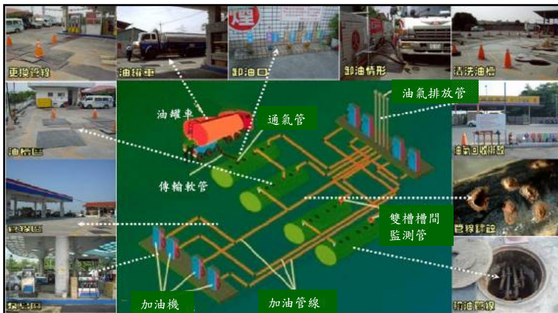
圖 2-1 常見之儲油系統配置及可能污染區域示意圖 [20]
