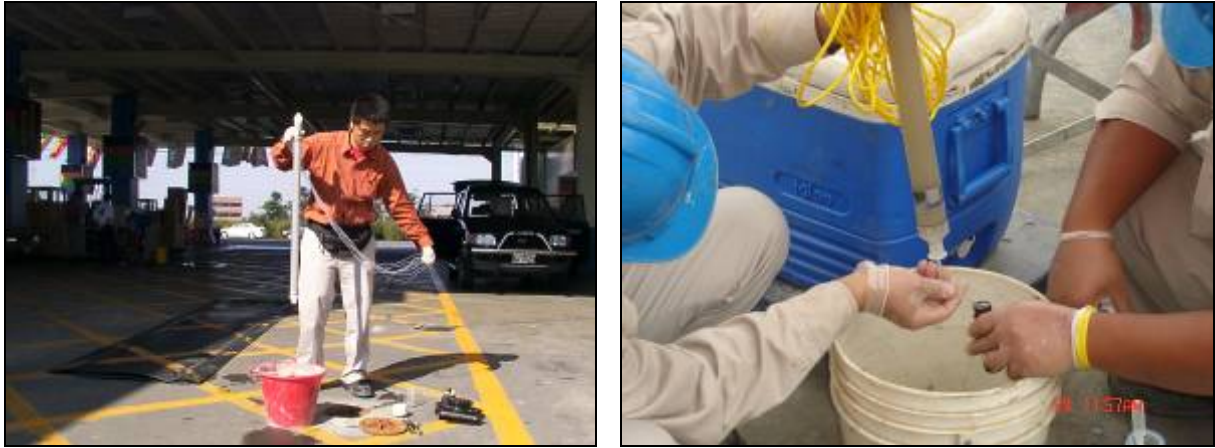
圖 4-10 貝勒管現場操作狀況
