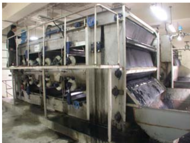
圖 22.7 帶濾式脫水機外觀
