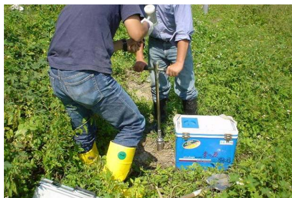
圖 4-6 土鑽採樣組及現場使用狀況
