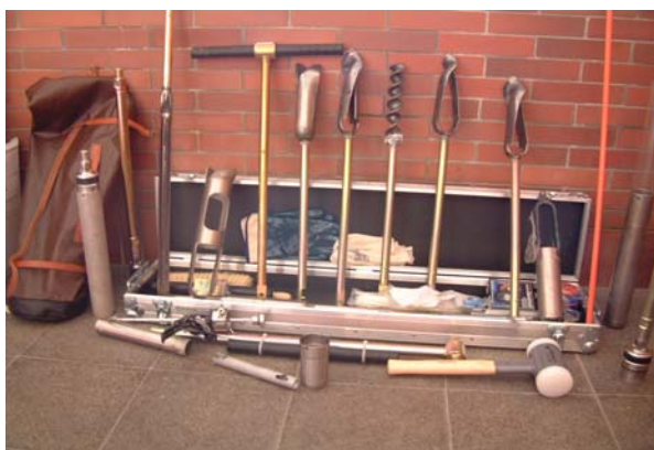
圖 4-6 土鑽採樣組及現場使用狀況
