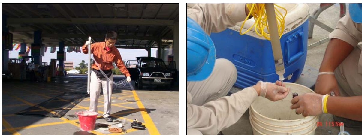
圖 4-10 貝勒管現場操作狀況
