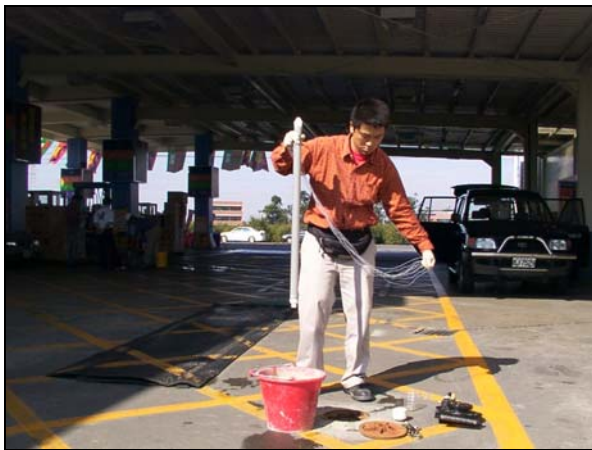
圖 4-10 貝勒管現場操作狀況
