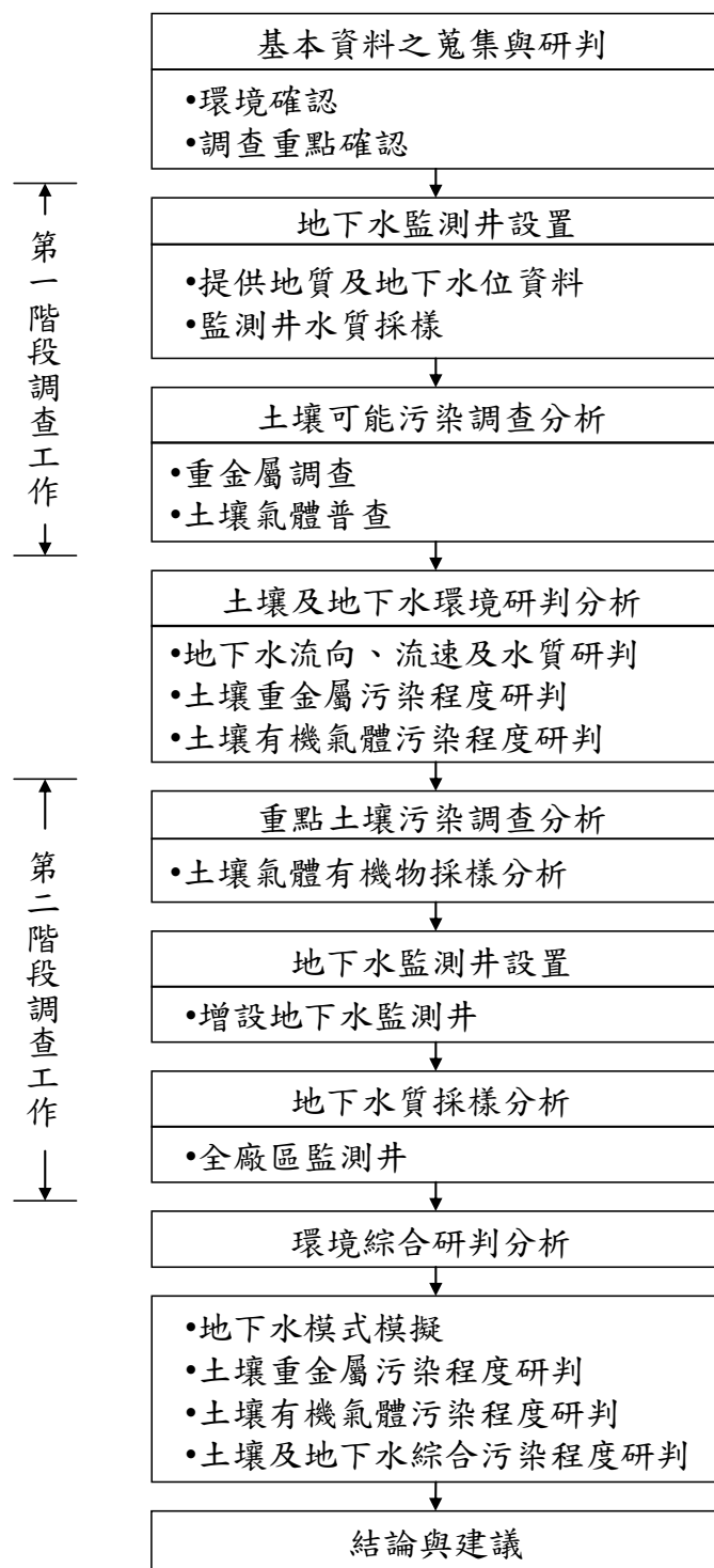
圖 3-4 工廠土壤及地下水品質監測計畫工作流程範例
