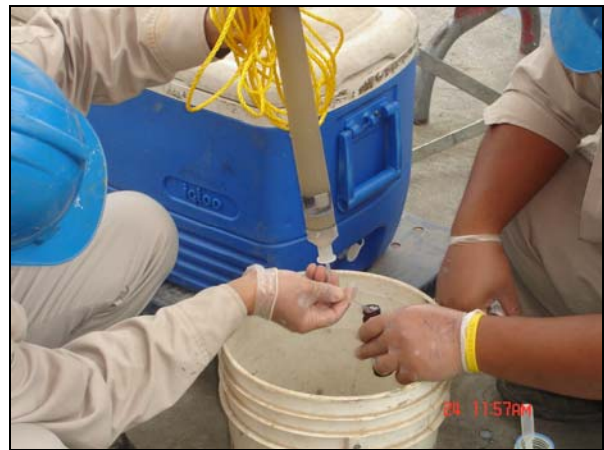
圖 4-10 貝勒管現場操作狀況
