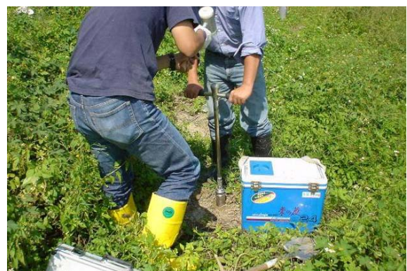
圖 4-6 土鑽採樣組及現場使用狀況
