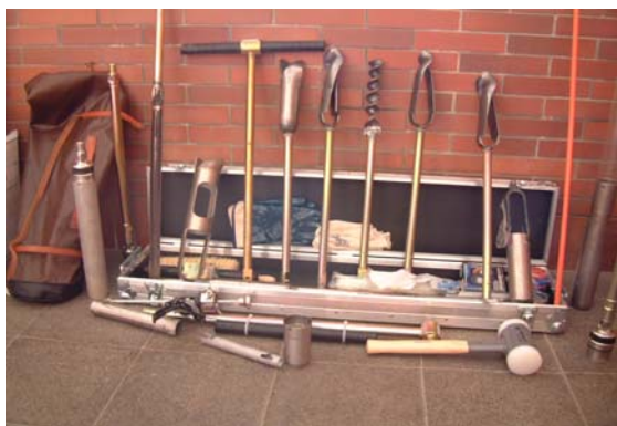
圖 4-6 土鑽採樣組及現場使用狀況
