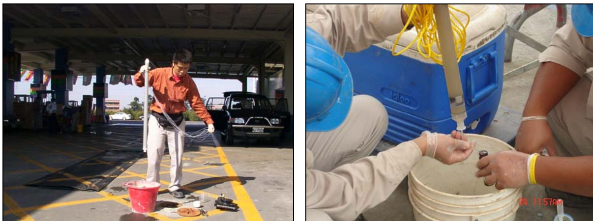
圖 4-10 貝勒管現場操作狀況
