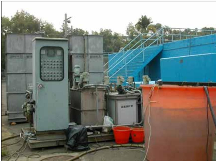
圖 2 活性污泥併同 PCBR 模廠單元照片
