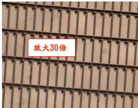
圖 4 僅含有電晶體之後玻璃基板
