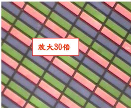
圖 3 含有網狀彩色濾光片、ITO 及電晶體之前玻璃基板
