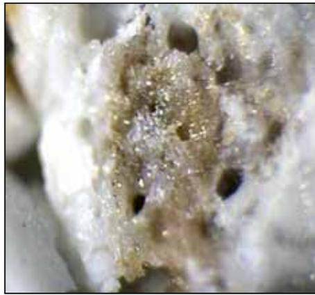
圖 11 多孔性陶瓷微觀照片(40x)
