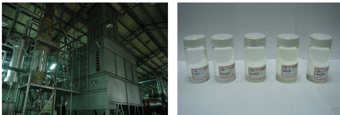
圖 2 凝核成長洗滌搭配浮動式活性碳床溶劑回收設備及回收含 Toluene、MEK 有機溶劑相片
