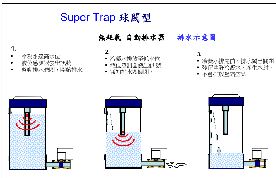
圖 2 球閥型無耗氣自動排水器排水動作圖
