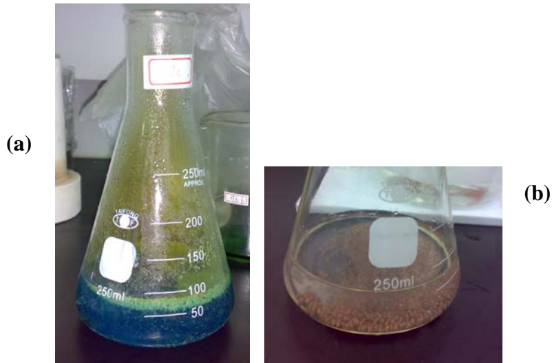
圖 2 (a)硝酸 5N 20°C 反應情形 (b) S3 反應結束後情形
